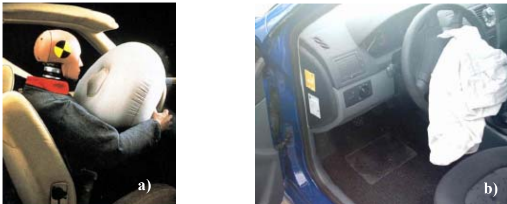
Slika 12.33 – Aktivirani vazdušni jastuk i jastuk nakon sipuštanja gasa
