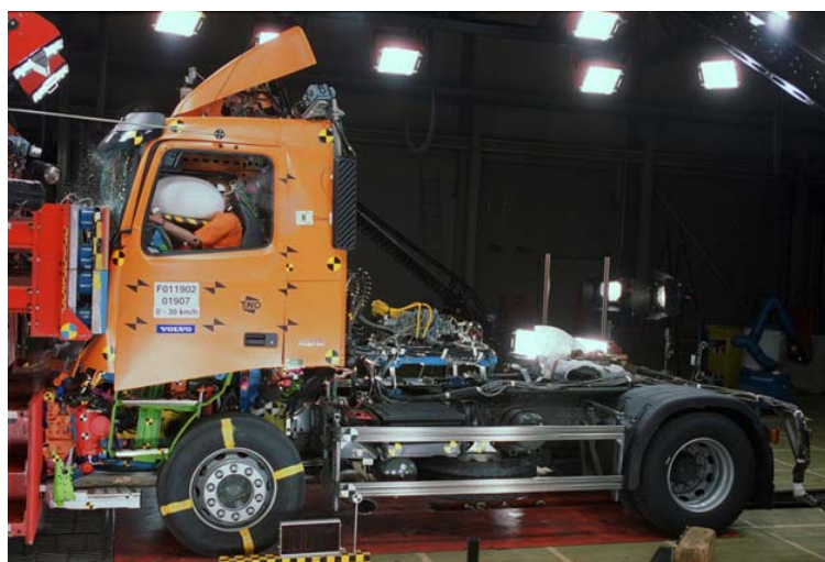
Slika 12.27 - Testiranje kamiona na čeonu sudar
