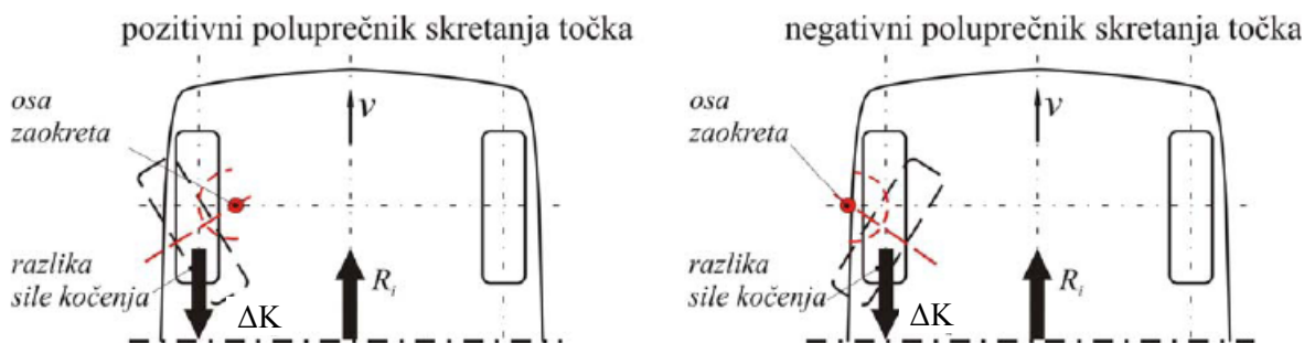
Slika 11.14 - Prednost negativnog položaja osovinice točka prilikom kočenja
