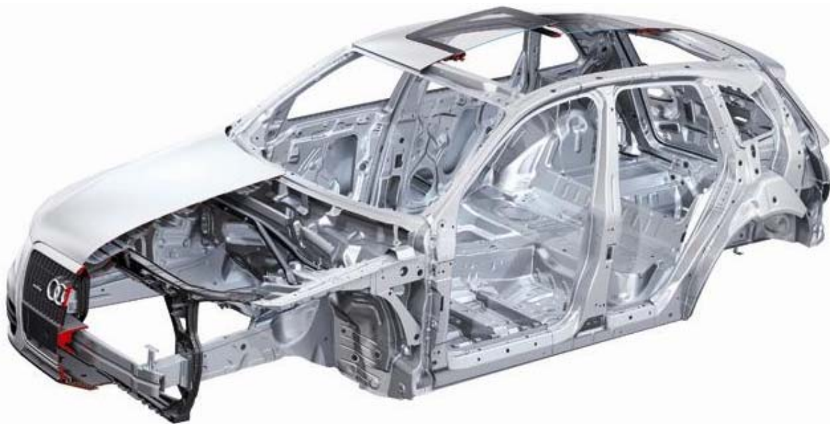
Slika 12.24 – Primer noseće strukture karoserije (Audi Q5)
