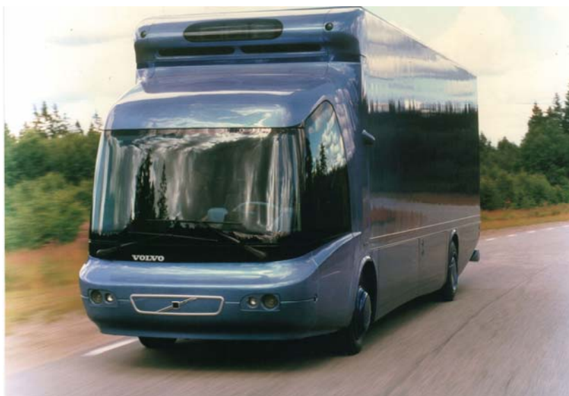
Slika 3.8 – Kamion sa gasnom turbinom (Volvo ECT)
