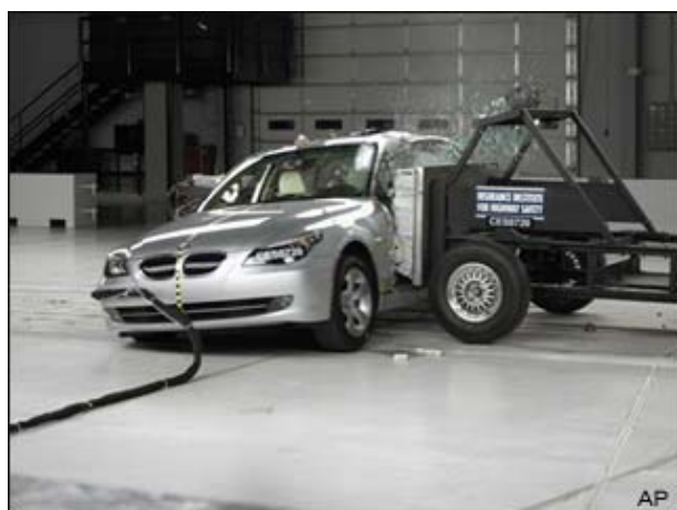
Slika 12.26 – Test na bočni sudar prema Direktivi 96/27/EC
