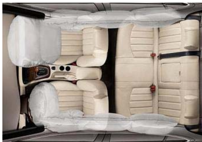
Slika 12.34 - Primer vozila sa aktiviranim prednjim i bočnim vazdušnim jastucima
