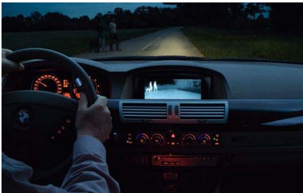
Slika 12.16 - Slika dobijena infracrvenim snimanjem na displeju u vozilu
