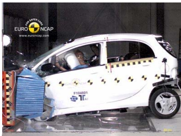
Slika 12.25 – Test čeonog sudara prema direktivi 96/79/EC
