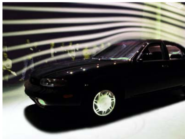
Slika 6.3 – Simulacija opstrujavanja profila vozila
