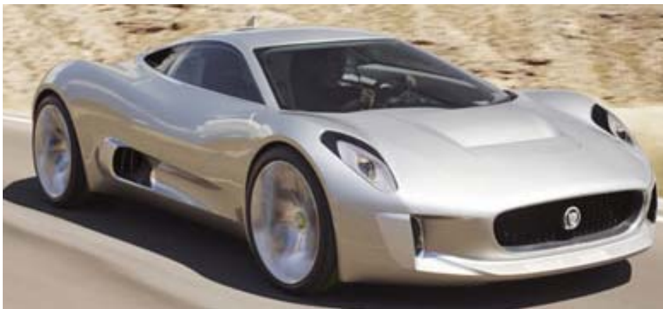
Slika 3.7 – Vozilo sa gasnom turbinom (Jaguar C-X75)
