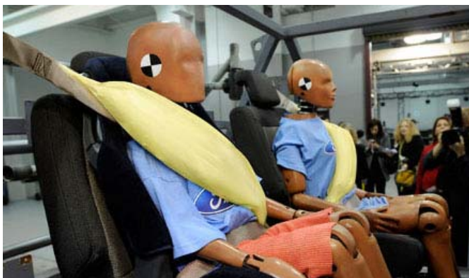
Slika 12.31 – Izgled pojaseva po novoj Ford-ovoj tehnologiji
