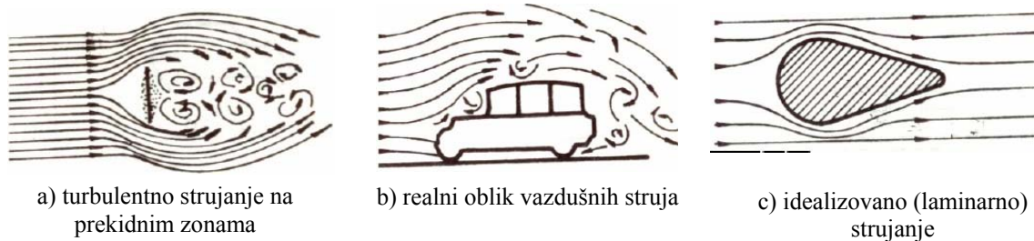
Slika 6.4 - Tok strujnica u tri karakteristična oblika
